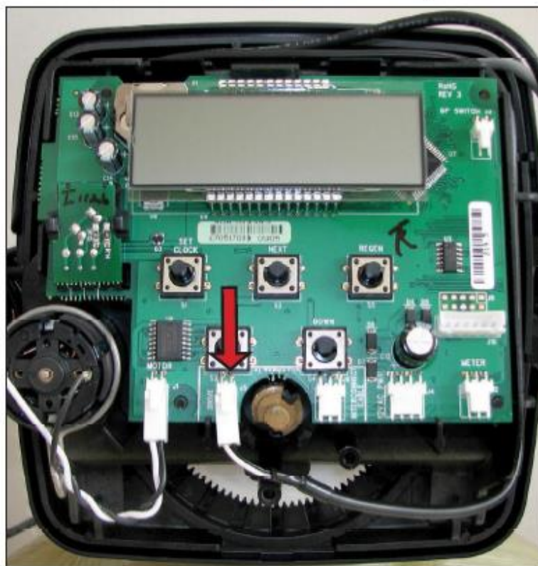
In poza de mai sus va este indicat unde sa introduceti cablul de la MAV
